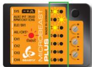
**Diese Schnellstart-Anleitung ist nur für die MICROBEAST PLUS Softwareversion 5.2.x gültig!** Die Version wird direkt nach dem Einschalten angezeigt, wenn die Status LED rot leuchtet. Die Menü LEDs **A** und **C** stehen für die Hauptversion „5“. In der rechten Spalte leuchtet die gelbe LED neben **1**. Das steht für Unterversion „2“.
