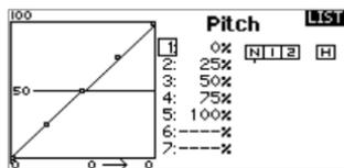
Jede Steu­er­funk­tion muss genau einen Servoausgang bedienen. Die Servowerte müssen auf 100% stehen und es darf keine Mischung verwendet werden. Verändere für die Einstellarbeiten nicht die Pitchkurven. Die Gaskurven und Einstellungen des Motorkanals können entsprechend an das Modell angepasst werden, falls die interne Drehzahlreglerfunktion von MICROBEAST PLUS nicht verwendet wird.
