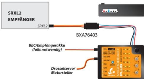
Spektrum® SRXL2 Satellitenempfänger mit 4-adrigem Anschlussstecker können direkt am MICROBEAST PLUS angesteckt werden. **ABERVORSICHT: Die Polarität des Steckers muss auf der Seite vom MICROBEAST PLUS vertauscht werden!** Beim MICROBEAST PLUS liegt auf dem äussersten Pin die Versorgungsspannung +3.3V, der Pin daneben ist Minus.
