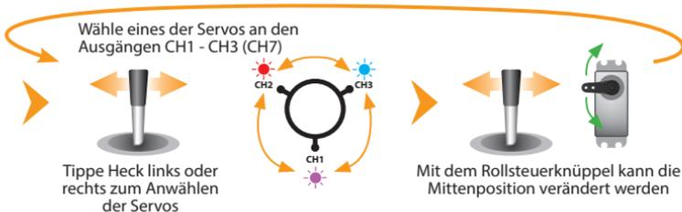
Wenn die Servos perfekt getrimmt sind passe die Anlenkgestänge entsprechend der Anleitung des Helis an und so, dass die Taumelscheibe mittig und im rechten Winkel zur Hauptrotorwelle ausgerichtet ist und die Rotorblätter 0° Pitchanstellwinkel haben. Stelle erst die unteren Gestänge ein, so dass die Taumelscheibe perfekt ausgerichtet ist und justiere dann den Anstellwinkel der Rotorblätter mittels der Anlenkgestänge zwischen Taumelscheibe und Blatthalter.
