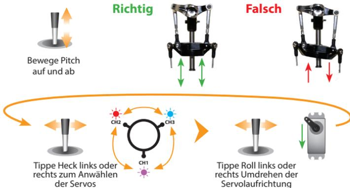
Achte auch darauf, dass die Pitchsteuerrichtung richtig ist. Dies ergibt sich entweder direkt durch korrektes Anpassen der Servolaufrichtungen, die Steuerrichtung kann aber auch über den Fernsteuersender durch Umdrehen des Pitchkanals geändert werden.
