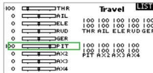
**⚠ Bei einem Elektromodell muss aus Sicherheitsgründen für die Dauer der Einstellarbeiten der Motor vom Hauptgetriebe abgekoppelt werden!** Deaktiviere zusätzlich die Ansteuerung des Motorkanals über den Schalter für die Autorotation (Throttle HOLD), damit der Motor nicht anläuft wenn der Pitchknüppel bewegt wird.
