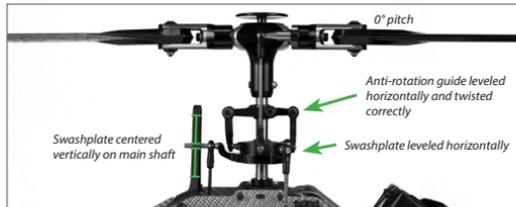
Falls vorgesehen stelle dann noch den Taumelscheibenmitnehmer korrekt ein, so dass die Mitnehmerarme bei 0° Pitch horizontal stehen und die Kugeln für die Blatthalteranlenkgestänge exakt 90° zu Blattlagerwelle stehen.
