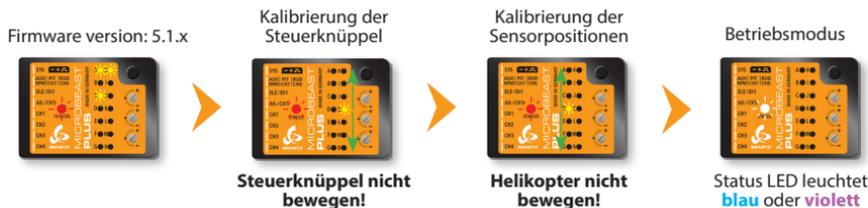
Öffne zum Durchführen der Grundeinstellung das SETUP MENÜ
