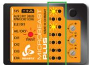
**Diese Schnellstart-Anleitung ist nur für die MICROBEAST PLUS Softwareversion 5.0.x gültig!** Die Version wird direkt nach dem Einschalten angezeigt, wenn die Status LED rot leuchtet. Die Menü LEDs **A** und **C** stehen für die Hauptversion „5“. In der rechten Spalte darf keine LED leuchten.
