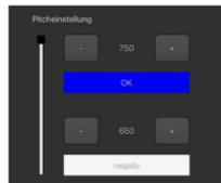
4. Lass den Pitch-Steuerknüppel in Maximalposition und stelle jetzt den gewünschten und zum Heli passenden Maximalwinkel mit den Knöpfen + und - in der App ein. Bring dann den Pitch-Steuerknüppel in die tiefste Position und stelle dann auch entsprechend das negative Pitch ein.
