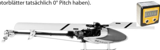
Betätige jetzt die Schaltfläche MESSEN, das NANOBEAST wird dann einen kleinen Steueraus Schlag auf Roll machen (die Richtung ist dabei unerheblich). In dieser Position sollten die Rotorblätter genau 6.0° Steueraus Schlag machen. Stelle den Zahlenwert so ein, dass dies der Fall ist.
