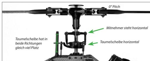
Falls vorhanden stelle dann noch den Taumelscheibenmitnehmer korrekt ein, so dass die Mitnehmerarme bei 0° Pitch horizontal stehen und die Kugeln für die Blatthalteranlenkgestänge exakt 90° zu Blattlagerwelle stehen.
