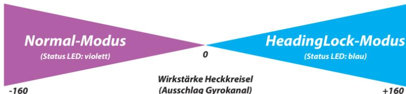
Stelle für den Anfang die Wirkstärke über den Sender so ein, dass der Heckkreisel mit 50 Wirkstärke und im HeadingLock-Modus betrieben wird (Status LED blinkt **4x blau**).
