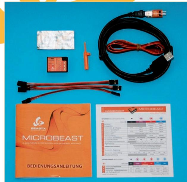
Der komplette Lieferumfang mit MICROBEAST, Kabel, Befestigungsmaterial, Anleitung, USB-Adapterkabel und Einstell-Schraubendreher. Rechts unten erkennt man die praktische Kurzanleitung, mit der man nach den ersten Erfahrungen auskommt.
