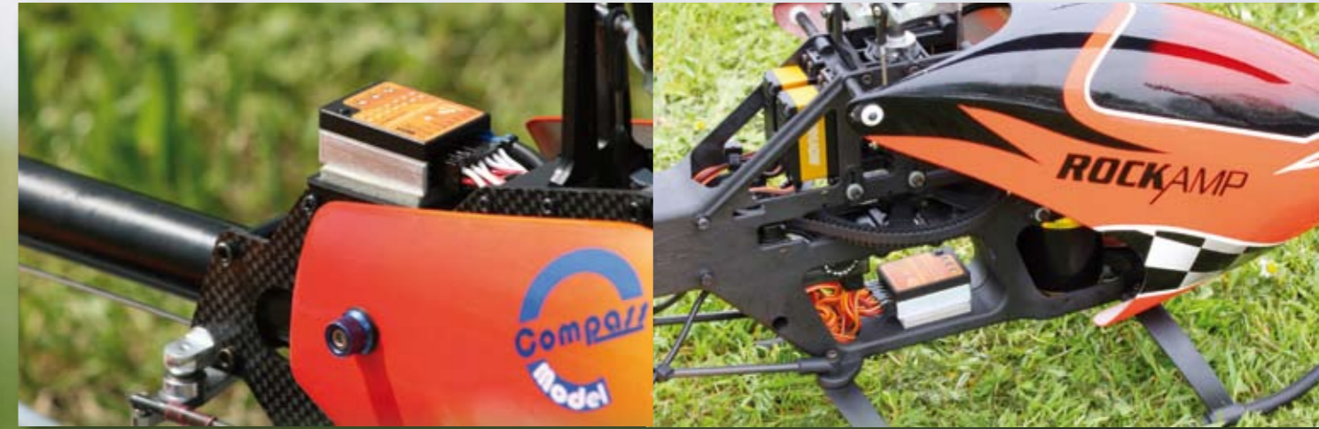
Zufriedenheit nicht nur bei unserem Dreifach-Test. Auch in anderen Modellen, hier ein 3D Plus und ein MSH Protos 500, ist mit Flybarless Flugspaß pur garantiert. Beim Einbau ist stets zu beachten, dass das microbeast orthogonal zur Rotorwelle ausgerichtet wird
