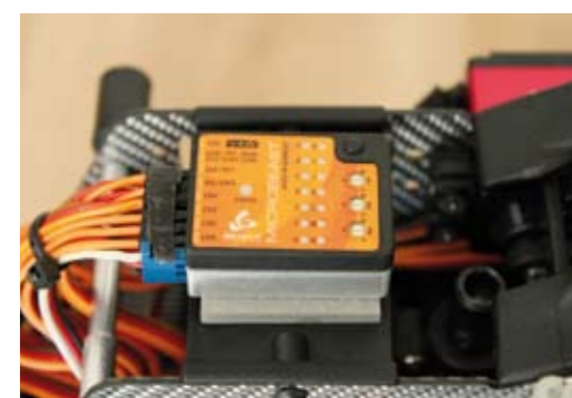
Sensor-Anordnung auf der Gyro-Plattform des 600 Nitro. Die Verkabelung wurde zusätzlich gesichert, um ein Lösen während des Flugbetriebes zu verhindern
