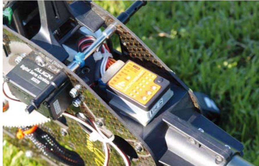
Das Chassis RCsolutions Evo 600 im Detail. In diesem T-Rex 600E von Darko Sabljo ist die Taumelscheibe ebenfalls direkt angelenkt. Durch den nach oben versetzten Motor ist reichlich Platz zur Akku-Anordnung im unteren Teil des Chassis vorhanden
