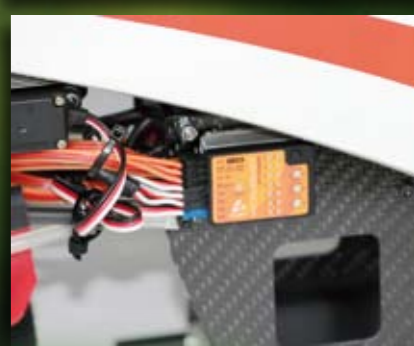
Eines der wenigen Mankos, mit dem man bei allen Flybarless-Systemen zu tun hat: Die ordentliche Verkabelung ist nicht immer ganz einfach
