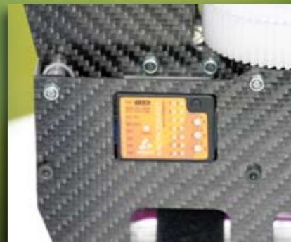
Zufriedenheit nicht nur bei unserem Dreifach-Test. Auch in anderen Modellen, hier ein 3D Plus und ein MSH Protos 500, ist mit Flybarless Flugspaß pur garantiert. Beim Einbau ist stets zu beachten, dass das microbeast orthogonal zur Rotorwelle ausgerichtet wird
