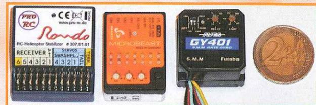
Comparaison des tailles avec le module flybarless Rondo essayé dans RC Pilot N°76 et un "simple" gyro Futaba GY 401.
