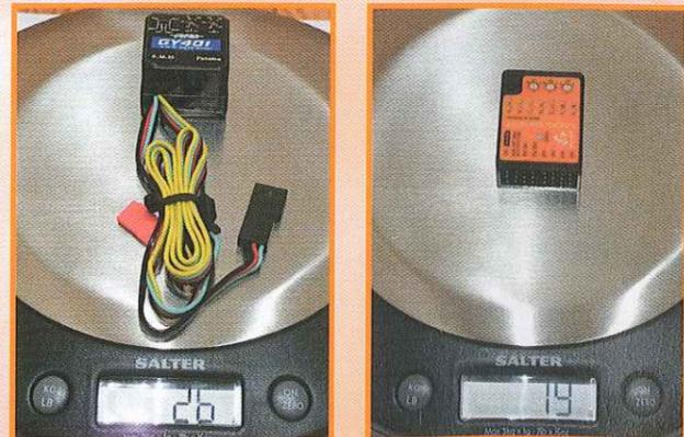
Sur la balance, les masses sont assez comparables, vu l'absence des câbles du côté du MicroBeast.
