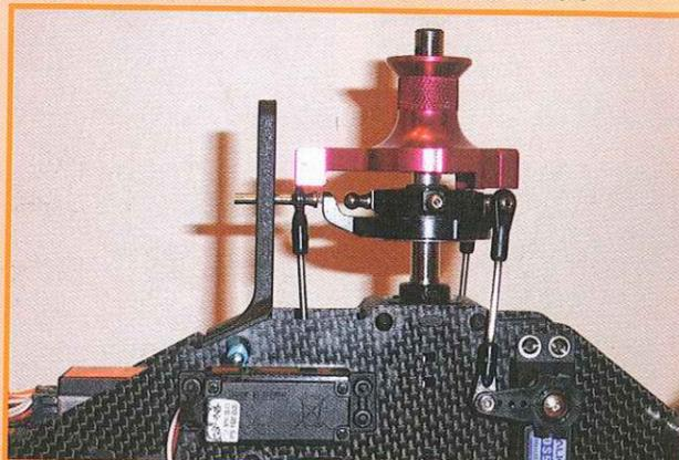
N'oubliez pas que l'usage d'un module Flybarless nécessite évidemment une nouvelle tête de rotor spécifiquement adaptée !
