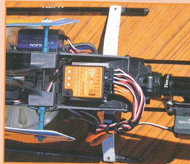
Ne tirez pas sur les câbles ! Cela évitera de transmettre les vibrations à l'électronique ou de décaler légèrement l'axe du module et donc le neutre des gyros. La petite taille du Microbeast permet d'envisager de le monter sur des hélicos de la classe "250".
