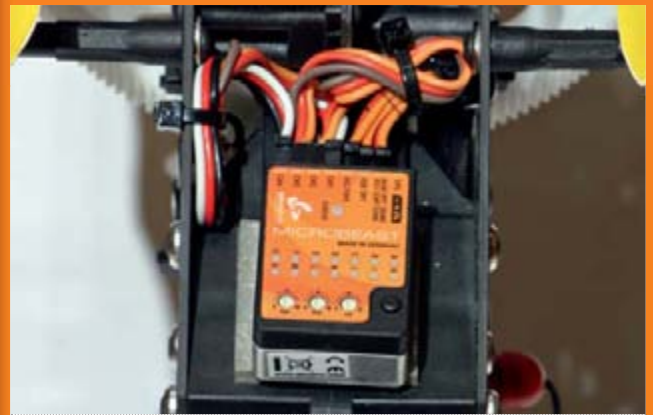
Für die Testflüge wurde das Microbeast beim T-Rex 600 ESP genau an der Stelle platziert, an der sich vorher der Gyro befand, so ist es für weitere Einstellungen sehr gut zugänglich.
