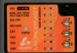
Über drei Drehpotis kann das System individuell angepasst werden. 14 LEDs zeigen an, in welchem Schritt man sich beim Setup befindet. Ferner ist noch die Status-LED auf der Oberseite untergebracht.
