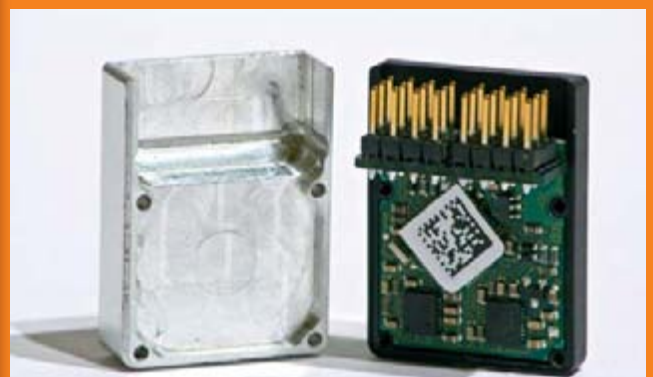
Die Elektronik des Microbeast sitzt in einem Alu-Block, der aus dem Vollen gefräst wurde.
