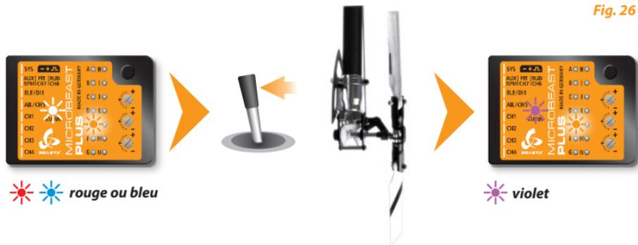
⚠ Si la LED status ne s'allume pas du tout, ou pas dans la bonne couleur, quand votre rotor d'anticouple a été positionné correctement sur ses limites, c'est que la course utile du servo est trop faible. Dans ce cas rapprochez vous d'un trou vers l'intérieur sur le palonnier du servo. Ceci assure que le gyro du module MICROBEAST PLUS pourra travailler correctement avec suffisamment de résolution.
