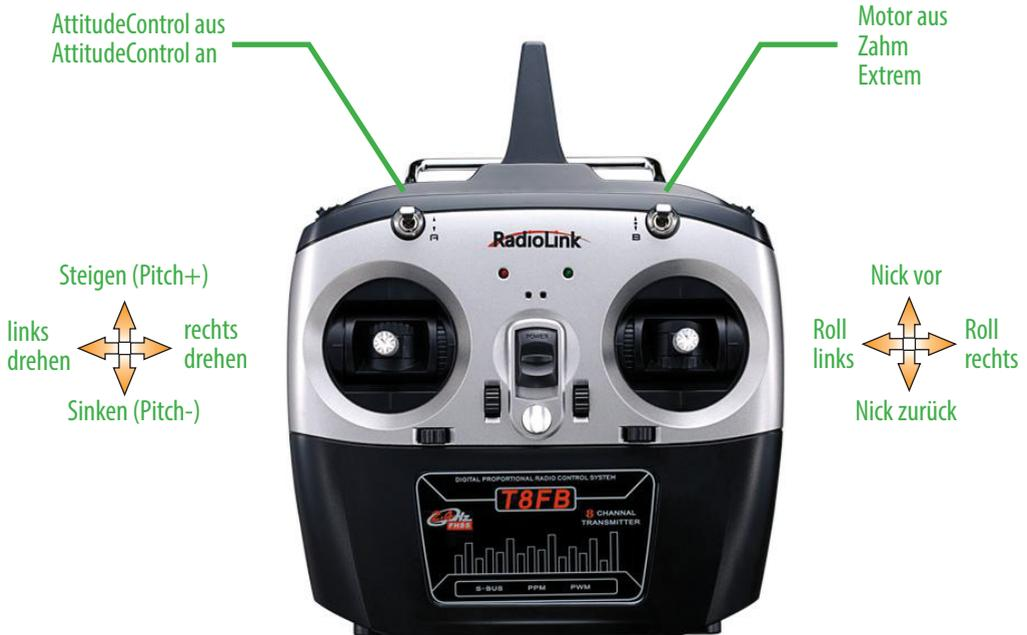
Jetzt wo Du weißt, wie Du was steuerst, prüfe im nächsten Schritt, ob die Funktionen auch richtig auf die Steuerkanäle verteilt sind. Das geht z.B. ganz einfach wenn Du die **Servomonitor** Funktion von Deinem Fernsteuersender betrachtest und die Steuerknüppel bewegst. Da sich die Zuordnungen der Steuerkanäle bei den Herstellern unterscheiden, siehst Du anhand der nachfolgenden Tabellen, wie die Steuerbelegungen bei Deiner Fernsteuerung eingestellt sein müssen.
