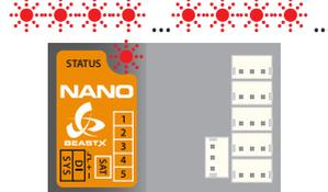
**Hinweis:** Wenn die Rettungsfunktion aktiv ist, dann gibt das System ständig Korrekturbefehle an die Servos. Das kann dazu führen, dass die Taumelscheibe eine starke Schräglage hat, wenn der Heli auf der Werkbank steht oder in der Hand gehalten wird. Nur bei abgeschalteter Rettungsfunktion zentriert sich die Taumelscheibe, wenn der Heli ruhig steht!
